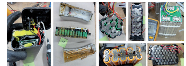
Geöffnete Batteriesysteme verschiedener Hersteller.
