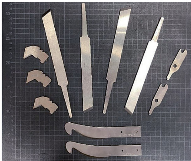
Erste Klingenrohlinge, entnommen aus einem Kreismesser.
