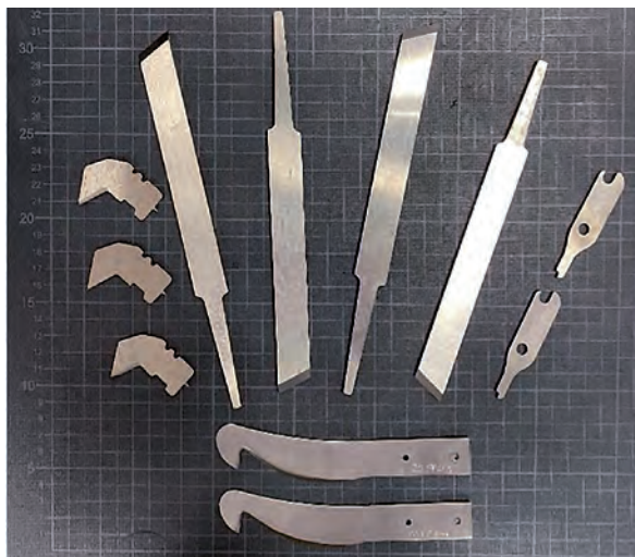
Erste Klingenrohlinge, entnommen aus einem Kreismesser.
