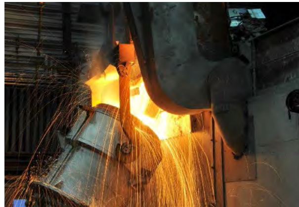
Abguss im Stahlwerk.
