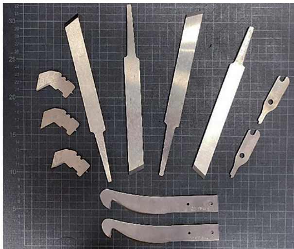
Erste Klingrohlinge, entnommen aus einem Kreismesser.
