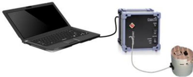
Abbildung 15: Der mobile Messaufbau für die Bestimmung von Farbechtheit und Änderungen der Oberflächenstruktur in VIS Bereich (Eigene Darstellung, HSRT)
