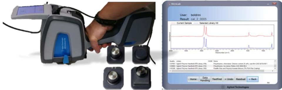
Abbildung 17: Das Agilent 7300 Handheld Fourier-Transformations-Infrarotspektrometrie (FTIR) Spektrometer (Eigene Darstellung, HSRT)
