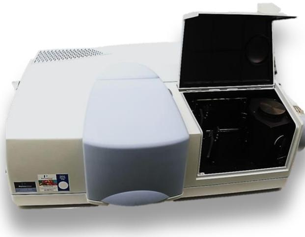
Abbildung 13: Das Zweistrahl-Spektrophotometer der Firma Perkin Elmer Lambda 1050 mit Ulbrichtkugel (Eigene Darstellung, HSRT)
