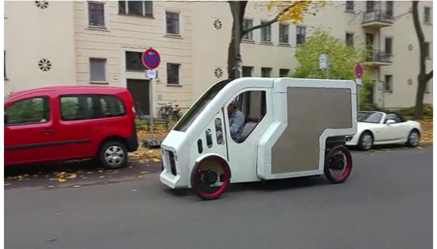
Videodokumentation einer Testfahrt Cargo Cruiser II (Light Electric Vehicle in Mischbauweise)
