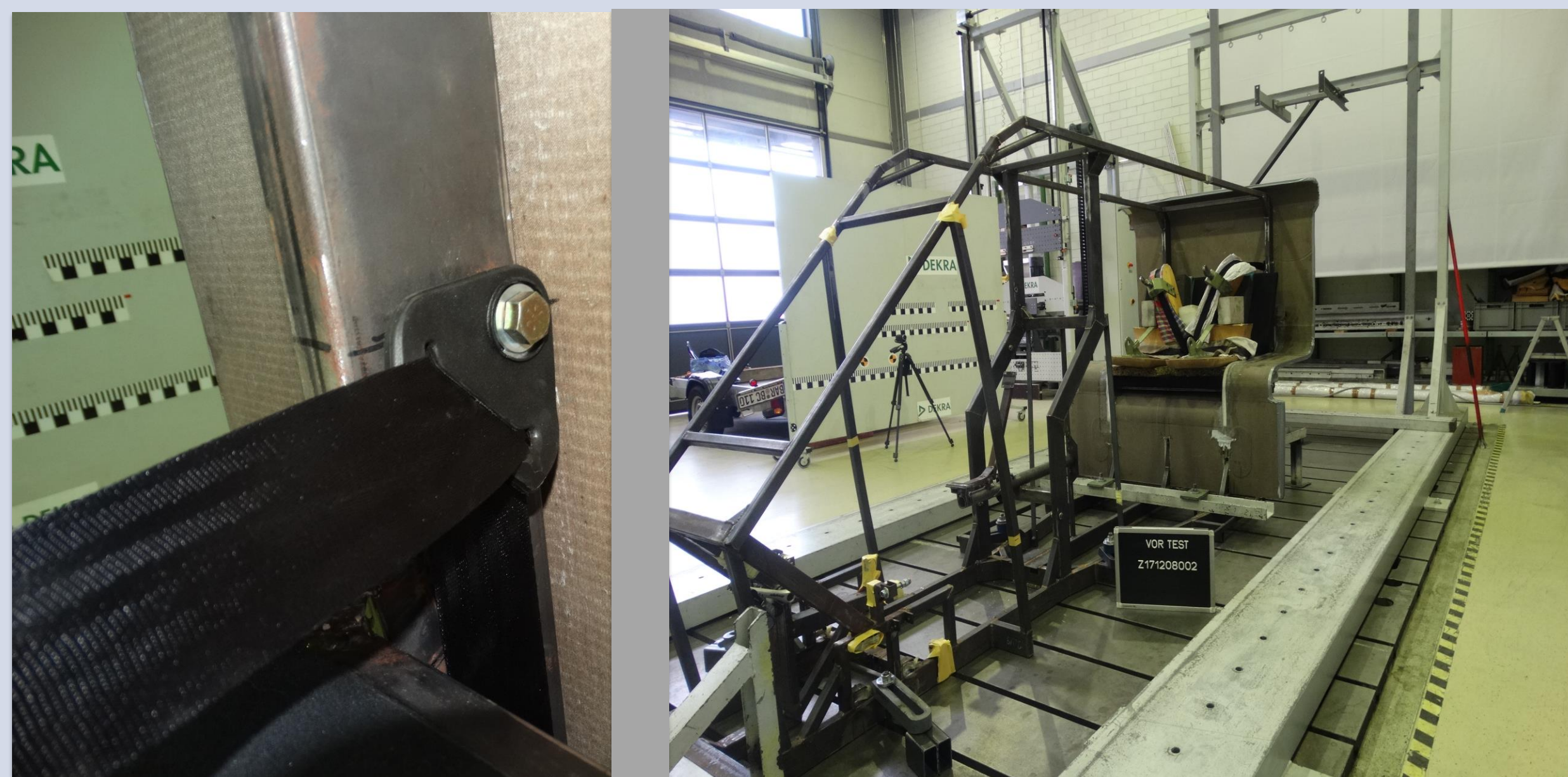
Gurtauszugstest an der Fahrzeugkonstruktion in Mischbauweise
