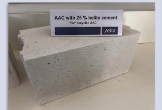
Ytong PP2-0,35 mit RC-Zementklinker aus Altporenbeton (Substitution PC = 25 %, Großversuch Xella T+F GmbH)
