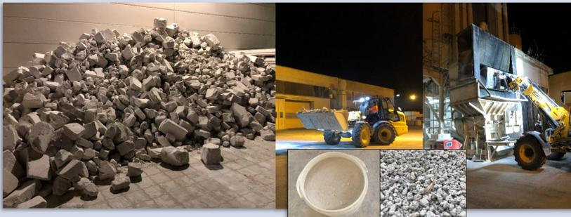
Bereitstellung von 25 t Altporenbeton durch Otto Dörner und Zerkleinerung zu Mehl/Granulat (Xella Granulatwerk Rotenburg, 30.10.2021)
