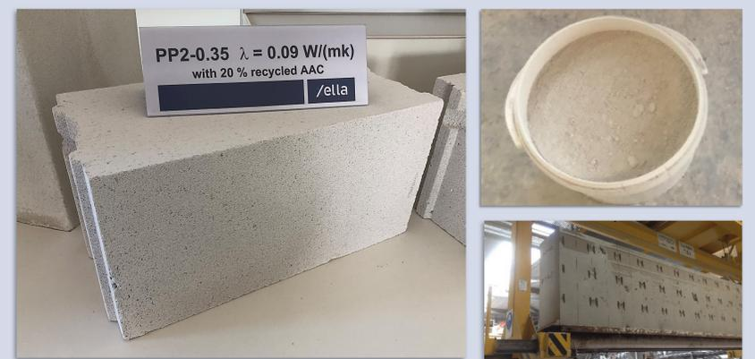
Ytong Planblock PP2-0,35 mit 20 M.-% Altporenbetonanteil (Format 499 x 240 x 249 mm, Probeproduktion Xella-Werk Freistett)
