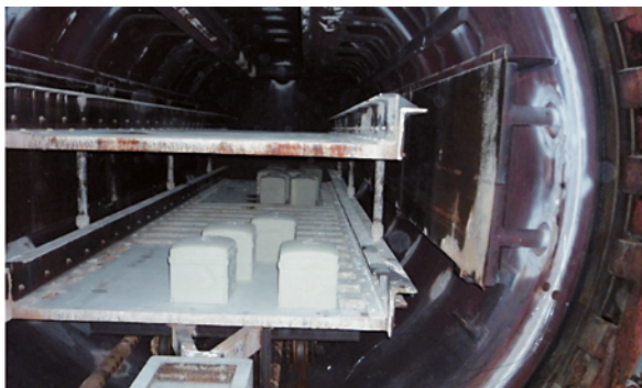
Porenbeton-Kleinversuchsprobekörper nach der Autoklavierung.
