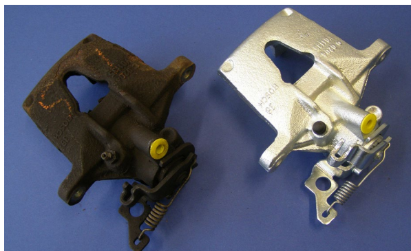
Aus Alt mach Neu: Altteil und aufgearbeitetes Teil, bereit für ein zweites Leben im Fahrzeug.
