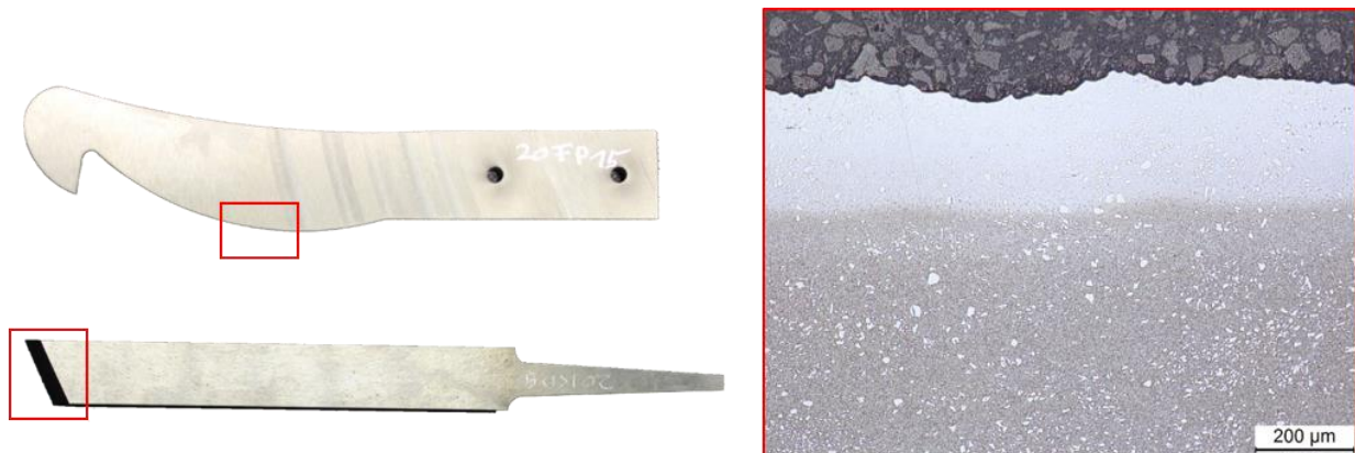
Abbildung 1-29: Darstellung der Wärmeeinflusszone die durch das Laserstrahlschneiden im Randbereich der Repurpose-Rohlinge induziert wird.
