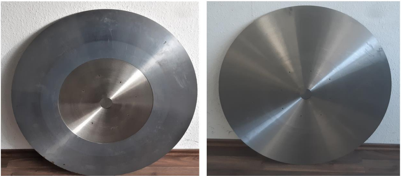
Abbildung 1-19: Demonstrator-Kreismesser nach der Bund- (links) und nach der Watenbearbeitung (rechts)
