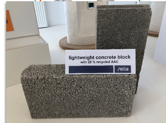
Leichtbetonstein mit 20 Vol.-% Granulat aus Altporenbeton (Qualität C)
