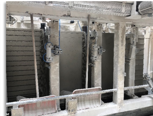
Abb.: Herstellung von 5 m 3 Porenbeton (Ytong® PP2-0,35) mit RC-Zementklinker im Großtechnikum der Xella Technologie- und Forschungsgesellschaft mbH Substitutionsrate OPC/Belit = 25 %
