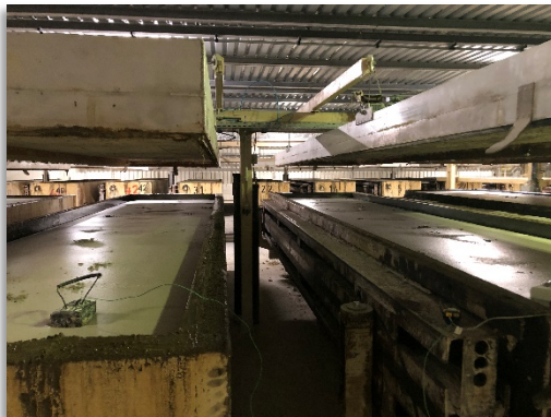
Abb.: Herstellung von 5 m 3 Porenbeton (Ytong® PP2-0,35) mit RC-Zementklinker im Großtechnikum der Xella Technologie- und Forschungsgesellschaft mbH Substitutionsrate OPC/Belit = 25 %
