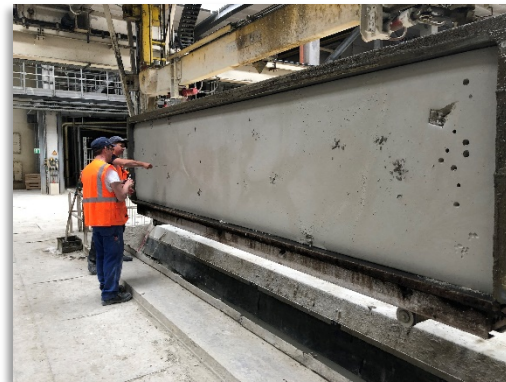
Abb.: Herstellung von 5 m 3 Porenbeton (Ytong® PP2-0,35) mit RC-Zementklinker im Großtechnikum der Xella Technologie- und Forschungsgesellschaft mbH Substitutionsrate OPC/Belit = 25 %
