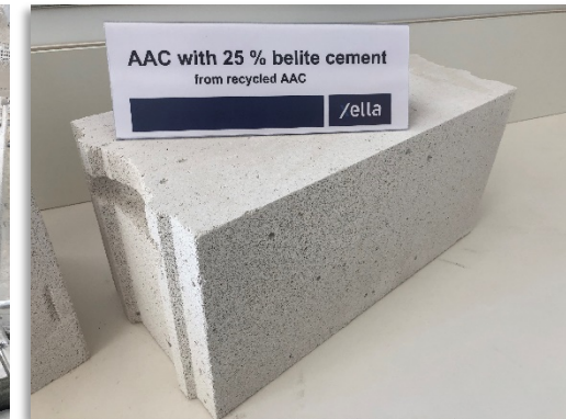
Abb.: Herstellung von 5 m 3 Porenbeton (Ytong® PP2-0,35) mit RC-Zementklinker im Großtechnikum der Xella Technologie- und Forschungsgesellschaft mbH Substitutionsrate OPC/Belit = 25 %
