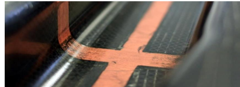
Exemplarische Darstellung integriertes, oberflächenneutrales Sensornetzwerk
