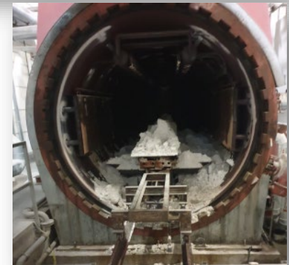
Oben: Kalksandstein Kleinformate mit 20% Porenbetonmehl
